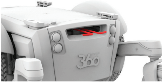
الشكل 4.4b - ب تحرير أذرع فرامل Magic 360
