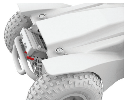
الشكل 4.6a - أ تعشيق أذرع الفرامل Extreme X8
