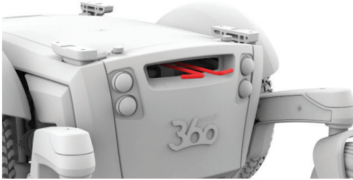
الشكل 4.4b - ب تحرير أذرع فرامل Magic 360
