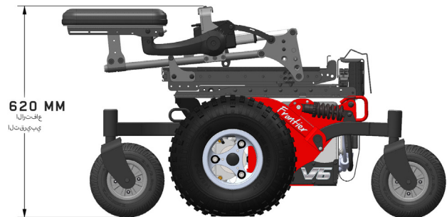
الشكل 4.3c - ج ارتفاع الطي للأمام V 4 و Frontier V6
