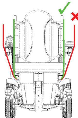
Фигура 5.1 Прокарване на ремъците за повдигане
