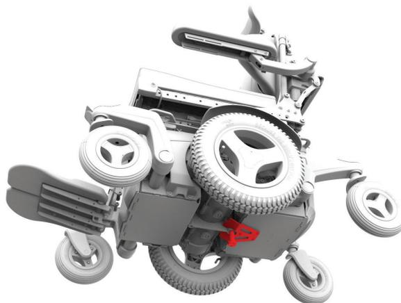
Фигура 5.7б Щифт за свързване на Magis 360 — изваден
