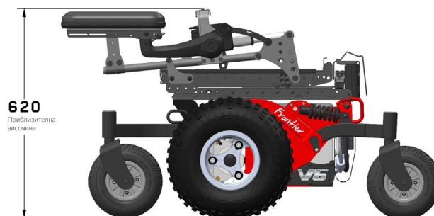
Фигура 4.3в Височина на Frontier V6 и V4 при сгъване напред
