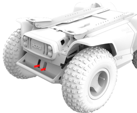
Фигура 4.7б Освободени лостове на спирачките на ХТ2 и ХТ4
