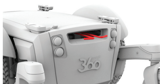
Obrázek 4.4b - Magic 360 - brzdové páky odpojeny
