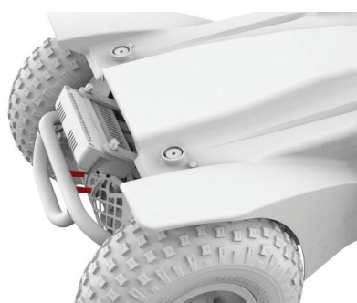
Obrázek 4.6b - Extreme X8 - brzdové páky odpojeny
