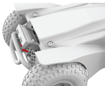
Obrázek 4.6a - Extreme X8 - brzdové páky připojeny
