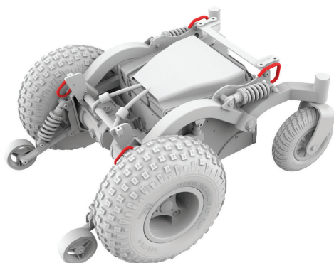
Obrázek 5.2c - Zvedací body modelu Frontier V4
