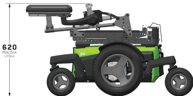
Obrázek 4.3b Magic 360 Sklopná výška vpřed
