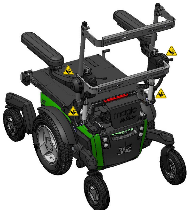
Figure 4.3a Roter Entriegelungsgriff für das Abklappen nach vorne
