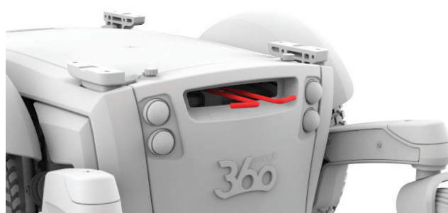
Figure 4.4b Bremshebel des Magic 360 – gelöst
