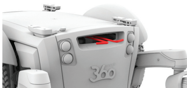
Figur 4.4b Magic 360 bremsearm deaktiveret
