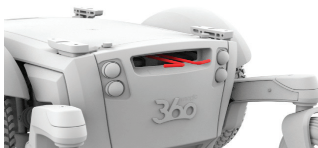
Joonis 4.4b. Magic 360 pidurihoovad on vabastatud
