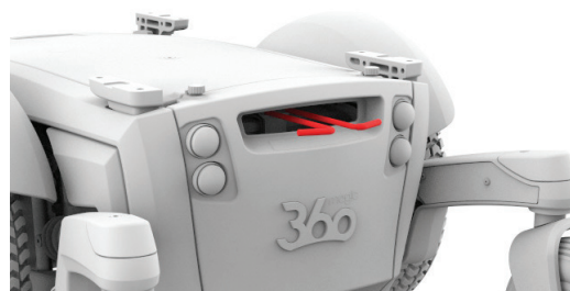
Figura 4.4b Palancas de freno de Magic 360 liberadas
