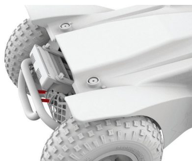
Figura 4.6b Palancas de freno de Extreme X8 liberadas
