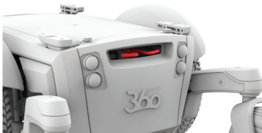
Figura 4.4a Palancas de freno de Magic 360 activadas
