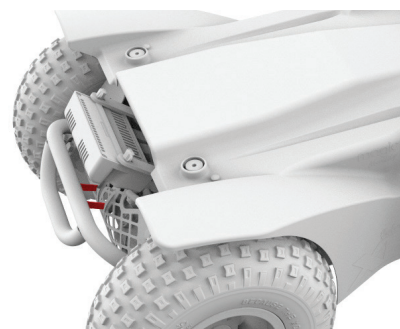
Figura 4.6b Palancas de freno de Extreme X8 liberadas
