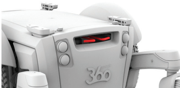
Figura 4.4a Palancas de freno de Magic 360 activadas
