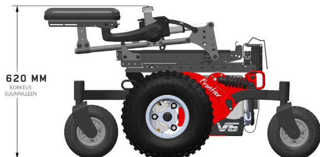
Kuva 4.3c Frontier V6 ja V4 taiton eteenpäin korkeus
