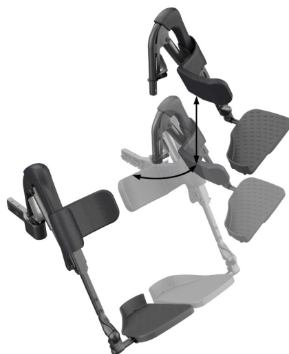
Figure 4.2c Repose-jambes montrant l'action d'escamoter pour le retrait
