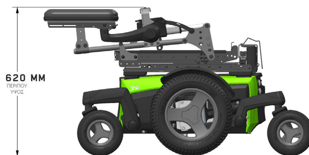
Εικόνα 4.3β Ύψος Fold Forward για το Magic 360
