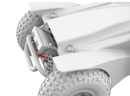
Εικόνα 4.6α Ενεργοποιημένοι μοχλοί φρένων στο Extreme X8
