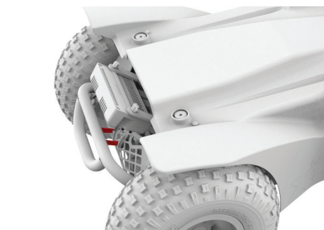
Εικόνα 4.6β Απελευθερωμένοι μοχλοί φρένων στο Extreme X8
