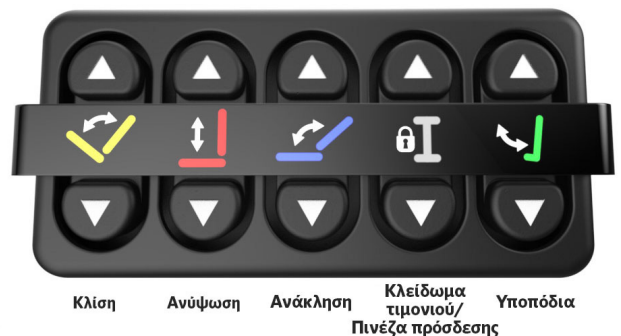
Εικόνα 4.10 Μια τυπική ρύθμιση του «ενεργοποιητή με ένα κλικ»
