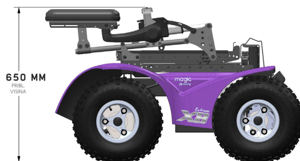
Slika 4.3d Visina preklopa naprijed za model Extreme X8
