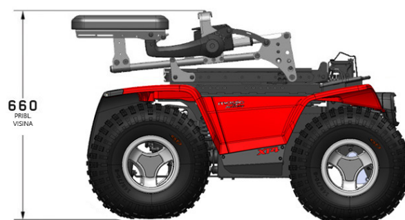
Slika 4.3f Visina preklopa naprijed za model XT4
