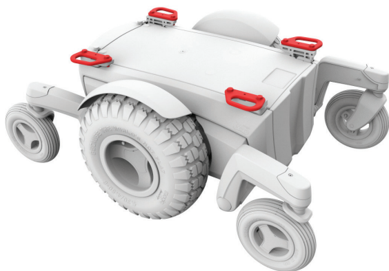
Slika 5.4a – pričvrstne točke za Magic 360
