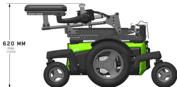
Slika 4.3b Visina preklopa naprijed za model Magic 360
