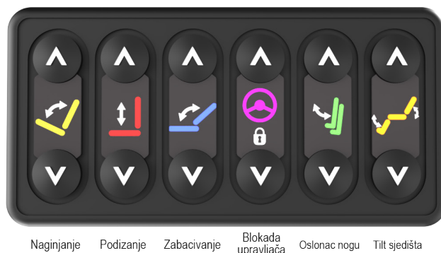
Slika 4.12 tipičan postava jednog klik aktivatora V2
