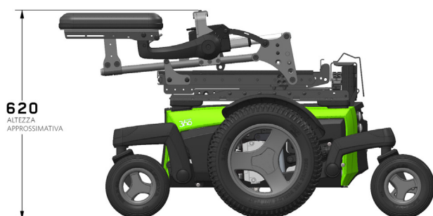
Figura 4.3b Altezza totale di Magic 360 con schienale abbattutto in avanti
