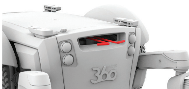
Figura 4.4b Leve dei freni di Magic 360 disinnestate
