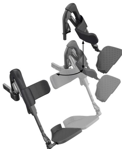
図 4.2c スイングアウェイ レッグレスト取り外し動作
