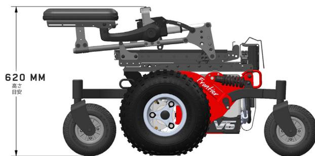
図 4.3c Frontier V6 / V4 前方折りたたみ時高さ
