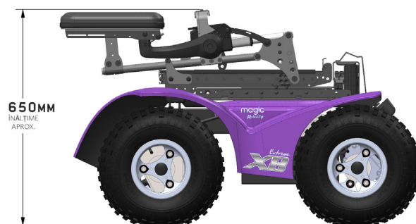
Figura 4.3d Extreme X8 pliabil în față pe înălțime
