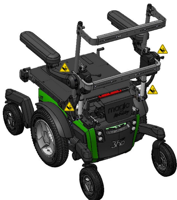
Figura 4.3a Mâner de prindere pliabil în față
