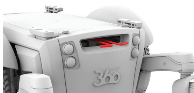
Figura 4.4b Magic 360 cu manetele de frânare eliberate
