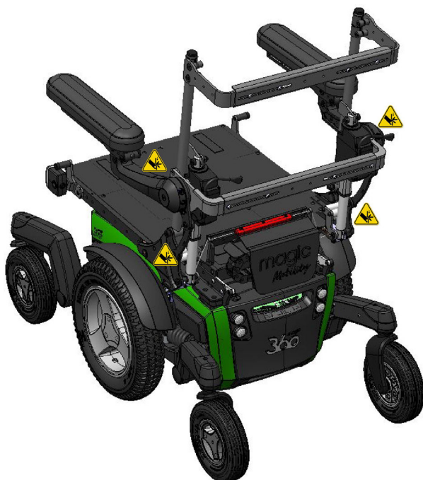
Slika 4.3a Ročaj za hrbtni naslon, ki se zloži naprej
