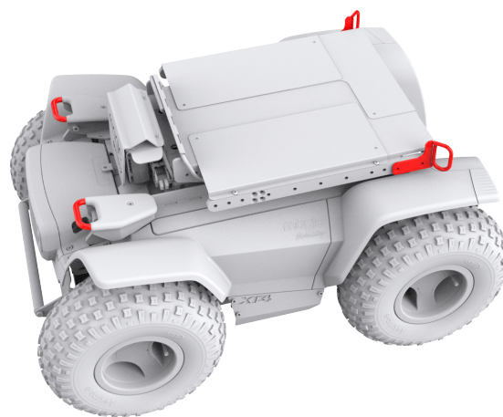
Slika 5.4f Pritrditvene točke XT4
