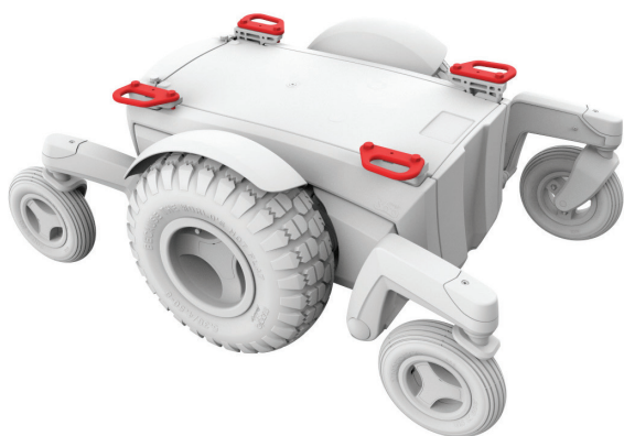
Slika 5.4a Pritrditvene točke Magic 360
