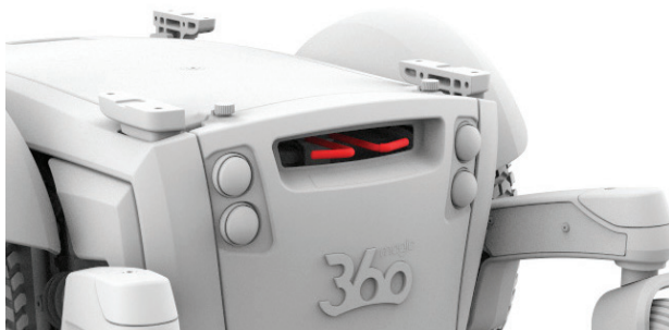
Obrázok 4.4a Brzdové páky Magic 360 zapnuté
