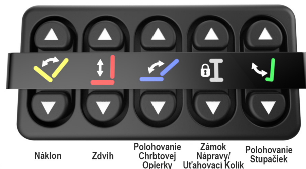
Obrázok 4.11 Typické nastavenie aktivátora jednorazového kliknutia V1
