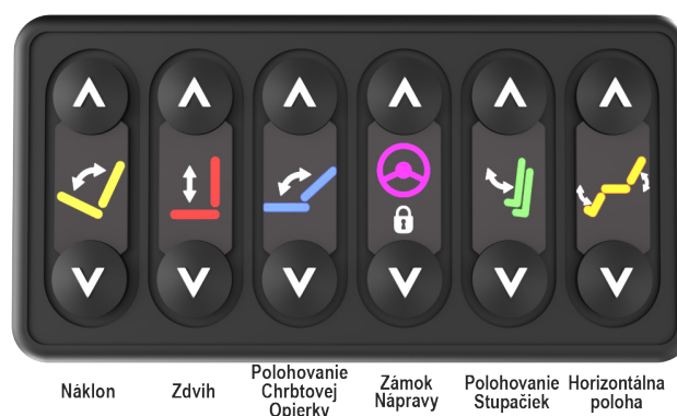
Obrázok 4.12 Typické nastavenie aktivátora jednorazového kliknutia V2
