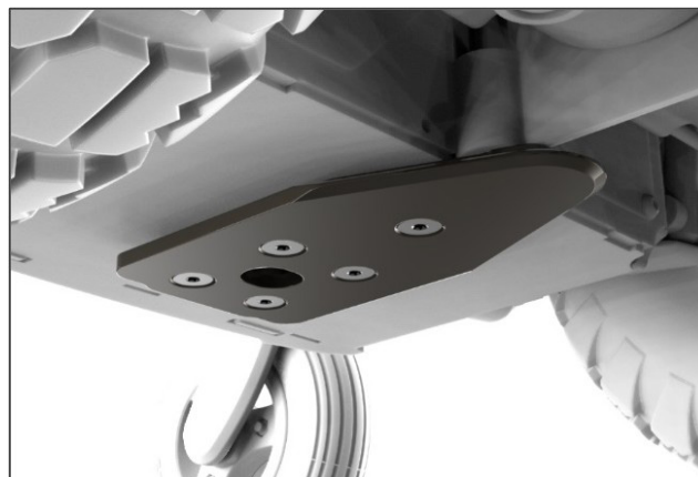
Figura 2: Placă de blocare Dahl montată pe baza Magic 360
