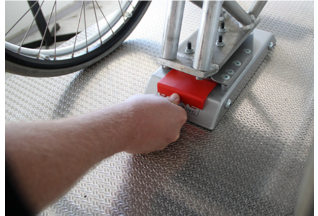
الشكل 4 ادفع أداة التحرير حتى يتم دفع دبوس التثبيت للأسفل
