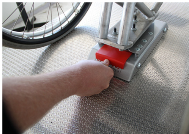
Fig. 4: Empuje la herramienta de liberación hasta que el pasador de acoplamiento se introduzca por completo.
