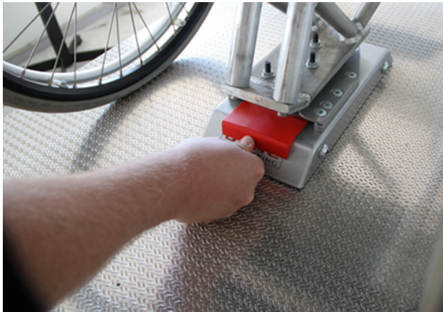
Kuva 4: Työnnä vapautustyökalua, kunnes lukitustappi pakottuu alas.
