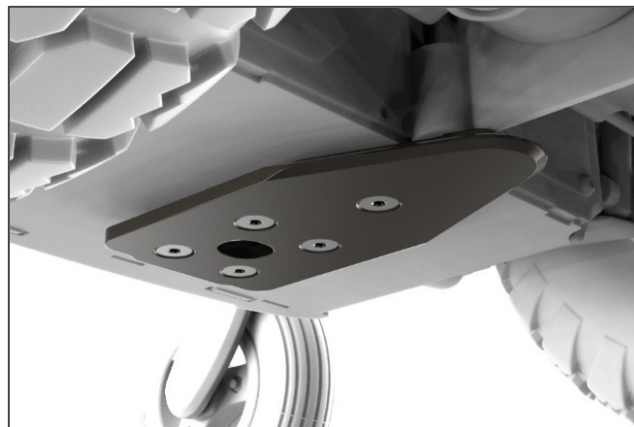
Kuva 2: Magic 360 -pyörätuolin alustaan asennettu Dahl-lukituslevy
