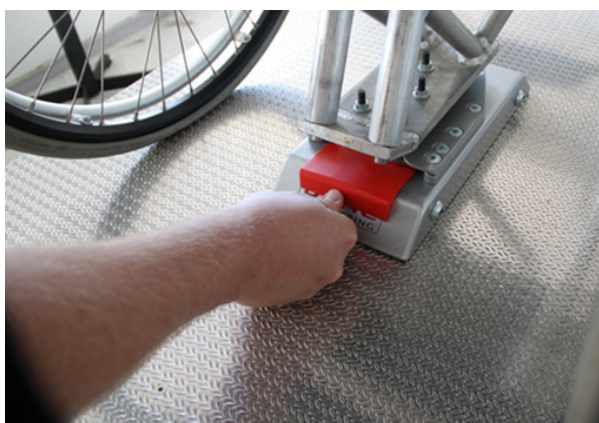
Fig. 4 : Enfoncez l'outil de libération jusqu'à ce que la goupille de verrouillage soit abaissée
