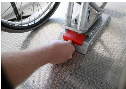
4 ábra: Tolja a vészkioldó eszközt addig, amíg a dokkolótüske le nem nyomódik.
