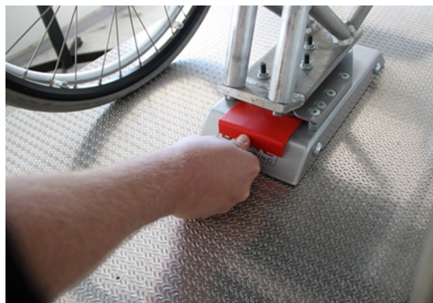
Figura 4: Inserire l'accessorio per il rilascio fino a quando il perno di blocco non verrà spinto in basso.
