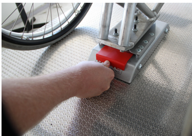
Fig. 4: Trykk nødutløserverktøyet til låsepinnen presses ned.
