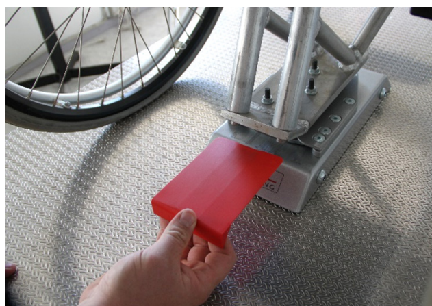
Fig. 3: Ferramenta de liberação de emergência
