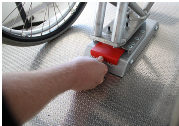
Fig. 4: Empurre a ferramenta de liberação até forçar o pino de fixação para baixo.
