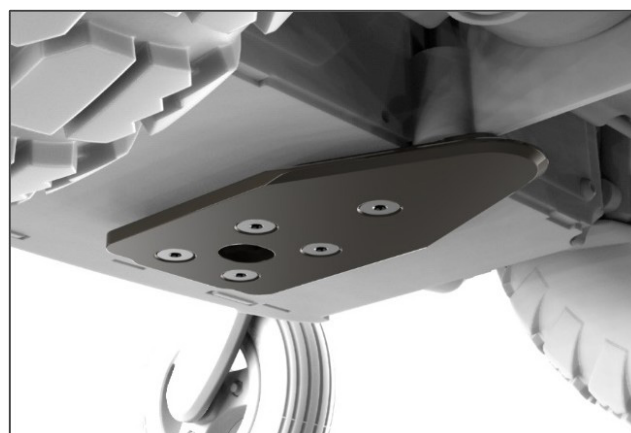
Fig. 2: Placa de fixação Dahl instalada na base da Magic 360
