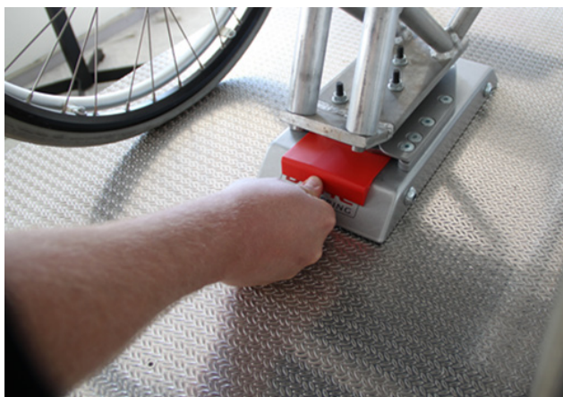
Fig. 4: Skjut på utlösingsverktyget tills dockningssprinten pressats ned.
