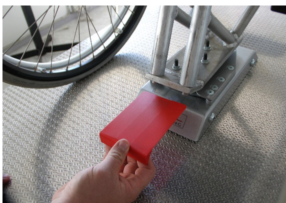
Slika 3: Orodje za sprostitvev v sili
