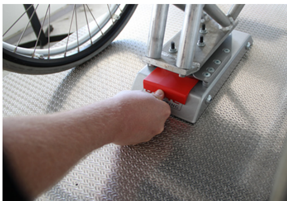
Slika 4: Potiskajte orodje za sprostitvev, dokler se priklopni zatič ne potisne navzdol.
