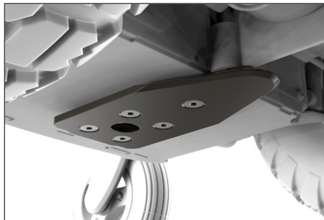
Slika 2: Zaklepna plošča Dahl, nameščena na podnožju Magic 360
