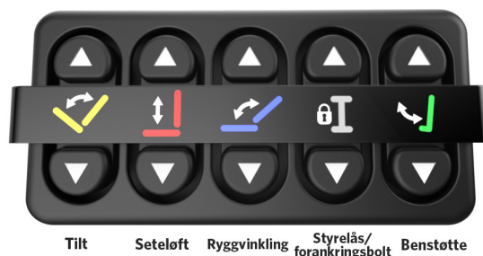
Figur 4.10 - Et typisk oppsett av ett-klikks-aktivering
