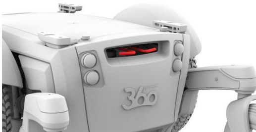
Figura 4.4a Palancas de freno de Magic 360 activadas
