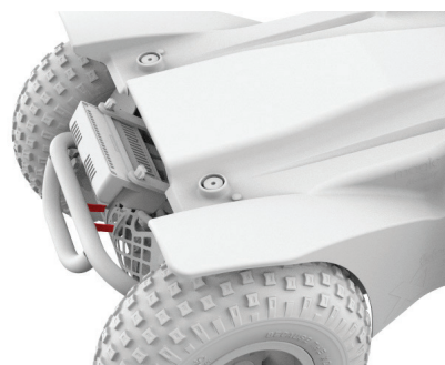
Figura 4.6b Palancas de freno de Extreme X8 liberadas
