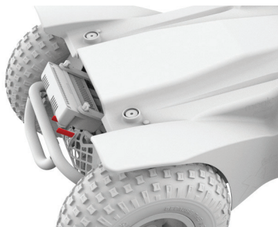
Figura 4.6a Palancas de freno de Extreme X8 activadas
