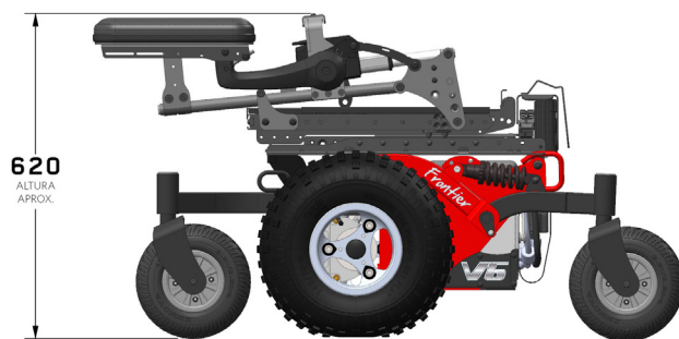
Figura 4.3c Altura plegado Frontier V6 y V4
