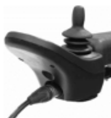
Figura 6.2 - Toma de carga
