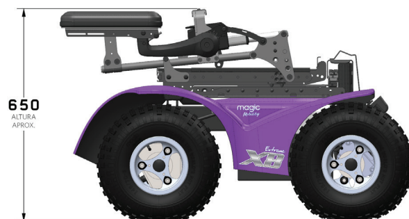
Figura 4.3d Altura do rebatimento da Extreme X8
