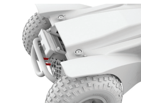
Figura 4.6b Alavancas dos travões da Extreme X8 libertadas
