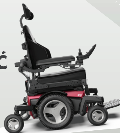
Koła napędowe 14" Urban zapewniają wyjątkową zwrotność w mieście (rozstaw 610mm / 24")
